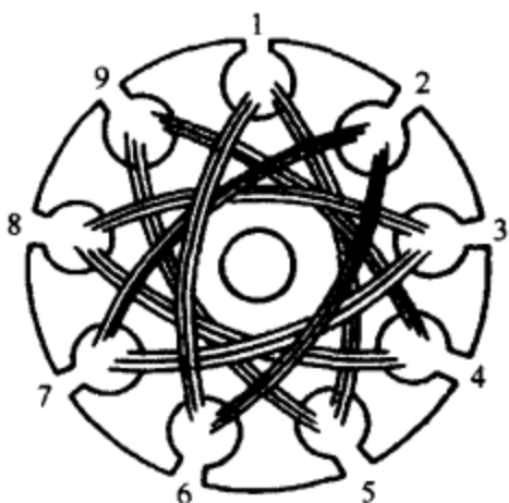
图 7-25 V形对绕式嵌线步骤
