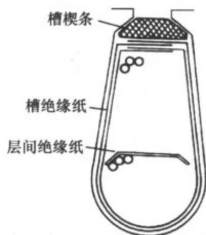
图 3-33 层间和槽口的绝缘处理
