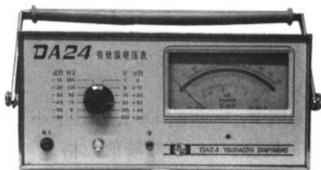
图5 有效值电压表 DA-24 外形
