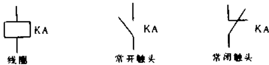
图 1-18 电磁式继电器图形、文字符号
