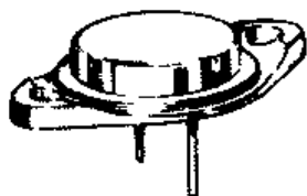
图 14.19 功率管通用的 TO3 封装形式。外壳是直径为 2.2 cm 的金属; “底座”的外直径约为 4 cm。“底座”上有两个螺孔, 用于与散热器之间的固定。集电极通常与外壳连接。这样, 一种具有电绝缘和热传导的衬垫材料就可以填充在外壳和散热器之间了
