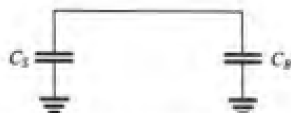
图 11.22 当被选中字线的电压上升时,晶体管导通,从而使存储电容 C_s 和位线电容 C_B 连通
