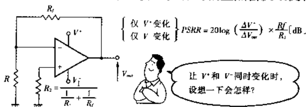
图 2.26 电源抑制比测量电路
