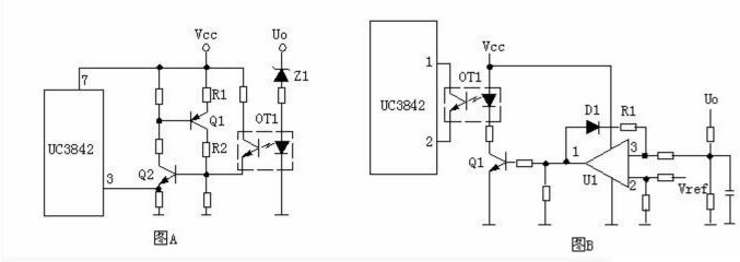
图 A 的工作原理是,当输出电压 Uo 升高,稳压管导通,光耦导通,Q2 基极得电导通,由于 Q2 的导通 Q1 基极电压降低也导通,Vcc 电压经 R1、Q1、R2 使 Q2 始终导通,UC3842③脚始终是高电平而停止工作。在图 B 中,UO 升高 U1③脚电压升高,①脚输出高电平,由于 D1、R1 的存在,U1①脚始终输出高电平 Q1 始终导通,UC3842①脚始终是低电平而停止工作。
