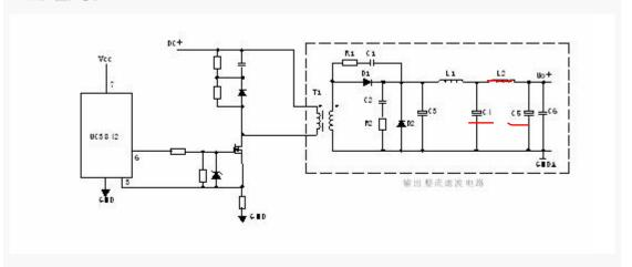
T1 为开关变压器,其初极和次极的相位同相。D1 为整流二极管,D2 为续流二极管,R1、C1、R2、C2 为削尖峰电路。L1 为续流电感,C4、L2、C5 组成  $\pi$  型滤波器。
