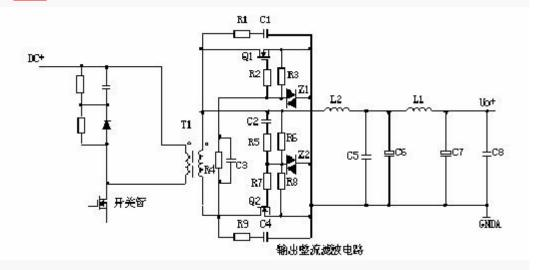
工作原理: 当变压器次级上端为正时,电流经 C2、R5、R6、R7 使 Q2 导通,电路构成回路,Q2 为整流管。Q1 栅极由于处于反偏而截止。当变压器次级下端为正时,电流经 C3、R4、R2 使 Q1 导通,Q1 为续流管。Q2 栅极由于处于反偏而截止。L2 为续流电感,C6、L1、C7 组成 π 型滤波器。R1、C1、R9、C4 为削尖峰电路。
