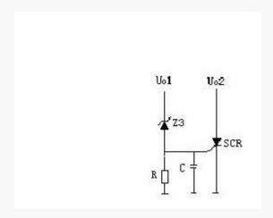
如上图,当 Uo1 输出升高,稳压管(Z3)击穿导通,可控硅(SCR1)的控制端得到触发电压,因此可控硅导通。Uo2 电压对地短路,过流保护电路或短路保护电路就会工作,停止整个电源电路的工作。当输出过压现象排除,可控硅的控制端触发电压通过 R 对地泄放,可控硅恢复断开状态。
