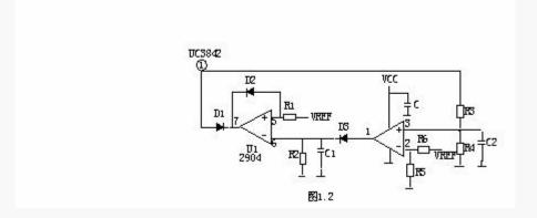
当输出短路, UC3842①脚电压上升,U1 ③脚电位高于②脚时,比较器翻转①脚输出高电位,给C1 充电,当C1 两端电压超过⑤脚基准电压时U1⑦脚输出低电位,UC3842①脚低于 1V,UCC3842停止工作,输出电压为 0V,周而复始,当短路消失后电路正常工作。R2、C1 是充放电时间常数,阻值不对时短路保护不起作用。
