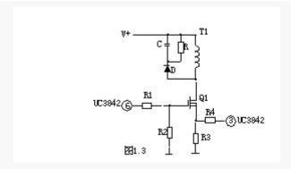
当输出电路短路或过流,变压器原边电流增大,R3 两端电压降增大,③脚电压升高,UC3842⑥脚输出占空比逐渐增大,③脚电压超过 1V 时,UC3842 关闭无输出。
