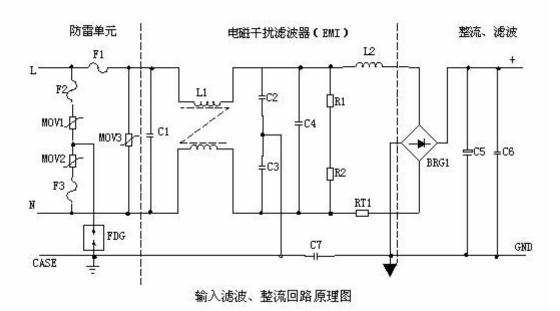
① 防雷电路:当有雷击,产生高压经电网导入电源时,由 MOV1、MOV2、MOV3: F1、F2、F3、FDG1 组成的电路进行保护。当加在压敏电阻两端的电压超过其工作电压时,其阻值降低,使高压能量消耗在压敏电阻上,若电流过大,F1、F2、F3 会烧毁保护后级电路。② 输入滤波电路:C1、L1、C2、C3 组成的双 π 型滤波网络主要是对输入电源的电磁噪声及杂波信号进行抑制,防止对电源干扰,同时也防止电源本身产生的高频杂波对电网干扰。当电源开启瞬间,要对 C5 充电,由于瞬间电流大,加 RT1(热敏电阻)就能有效的防
