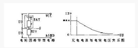
在充电的过程中,电流经 Q3、RLY1-B、F1、BAT、R20 回到地(AGND)。在电池充电的初期,因电池电压比较低,流经 Q3、RLY1-B、F1、BAT、R20 的电流就会增大,那么在 R20 上产生的压降就会增大(R20 为电流取样电阻)。电阻 R20 的上端 S 点经 R11 连接到 U2B 的同相输入端⑤脚,U2B 的反相输入端⑥脚有一固定参考电压,当 R20 上的压降超过参考电压时,U2⑦脚输出高电平,经 D2、R15 给 Q1 提供偏置电压,Q1 因此导通。Q1 导通后 Q2 因失去基极电压而截止,将使线性稳压器的输出关断,Q3、RLY1-B、F1、BAT、R20 回路中就没有电流流过,R20 上的压降消失,U2⑦脚输出低电平,Q1 截止,Q2、Q3 导通继续充电,如此周而复始,就将充电电流限制在某一设定值范围内。
