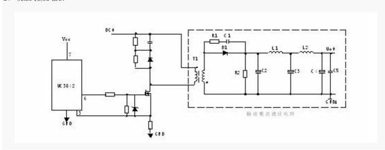
T1 为开关变压器,其初极和次极的相位相反。D1 为整流二极管,R1、C1 为削尖峰电路。L1 为续流电感,R2 为假负载,C4、L2、C5 组成 π 型滤波器。
