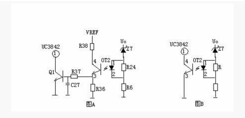
如上图,当 Uo 有过压现象时,稳压管击穿导通,经光耦(OT2) R6 到地产生电流流过,光电耦合器的发光二极管发光,从而使光电耦合器的光敏三极管导通。Q1 基极得电导通,
