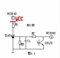
当输出电路短路,输出电压消失,光耦 OT1 不导通,UC3842①脚电压上升至 5V 左右,R1 与 R2 的分压超过 TL431 基准,使之导通,UC3842⑦脚 VCC 电位被拉低,IC 停止工作。UC3842 停止工作后①脚电位消失,TL431 不导通 UC3842⑦脚电位上升,UC3842 重新启动,周而复始。当短路现象消失后,电路可以自动恢复成正常工作状态。
