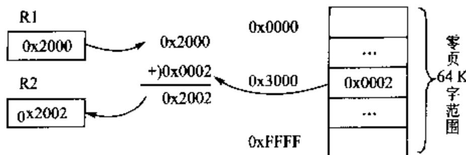
图 3-1 R2 = R1 + 0x3000 指令 16 位地址直接寻址操作示意
