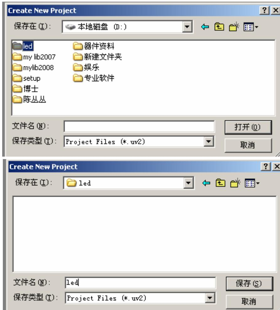
键入工程文件名 led ， 点击保存按钮。 出现选择器件型号对话框： 选择实验板上的所用芯片的型号 atmel->at89s51
