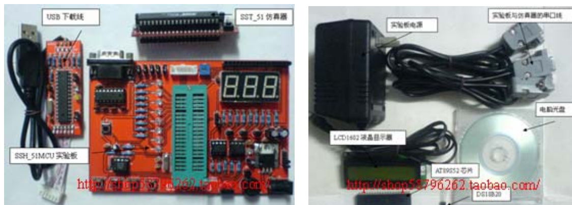
(SSH_51MCU 实验板，SST_51 仿真器，USB_ASP 下载线，配套工具)图 1-1
