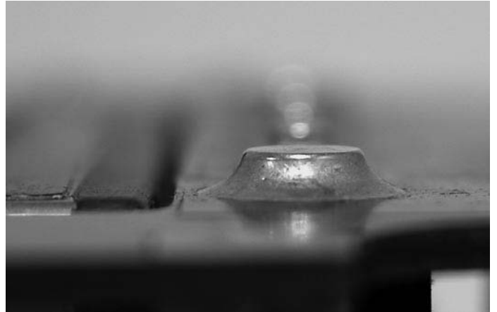
图 2—Mini 模块焊点侧图
