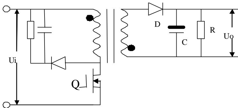
已知反激变压器工作条件和参数如下，请按要求设计变压器并完成关键元器件选型。
